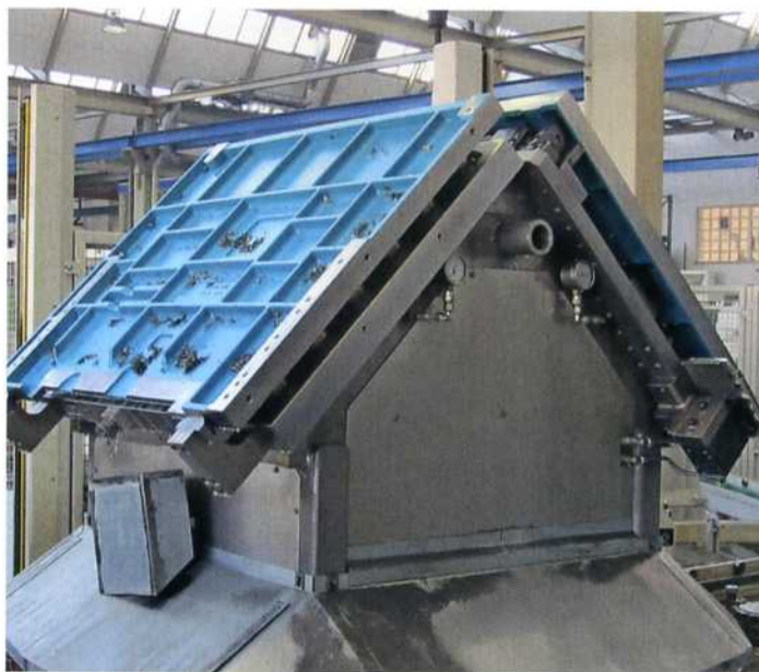
Zwei Rohteile werden gegeneinander aufgestellt, wobei eines auf der Oberseite und eines auf der Unterseite bearbeitet wird. So entsteht bei jedem Durchgang ein Fertigteil
