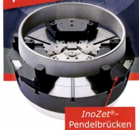
Kernstück der Unispeed-Baureihe: Kompakter und kraftvoller Orthogonalkopf, der 64 800 Positionen anfahren kann
