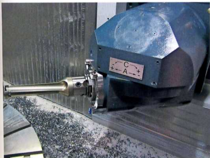
Kernstück der Unispeed-Baureihe: Kompakter und kraftvoller Orthogonalkopf, der 64 800 Positionen anfahren kann
