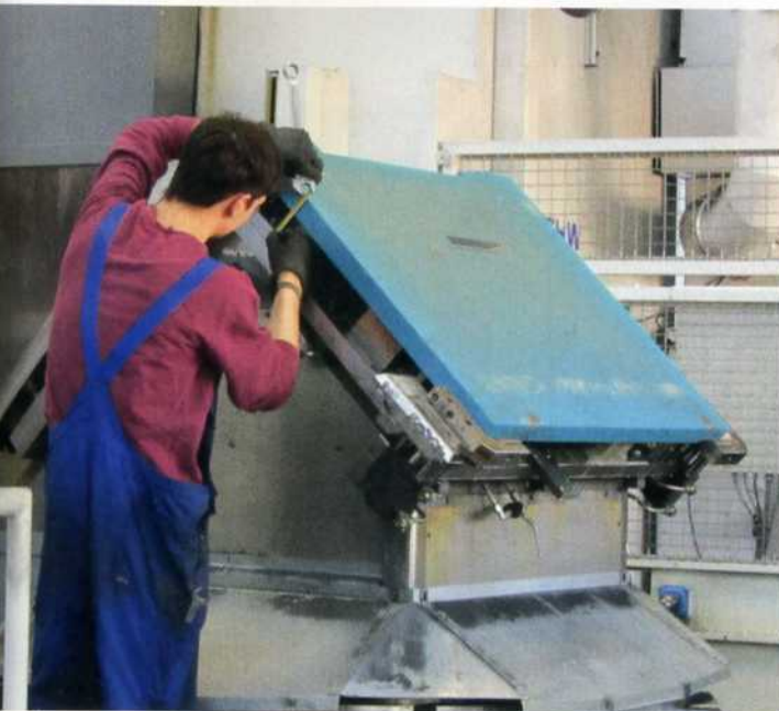
3 Während ein Teil bearbeitet wird, können hauptzeitparallel weitere Werkstücke vorgerüstet werden.
