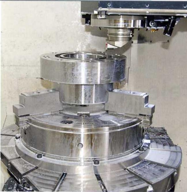
**2** Röhmspannfutter hat beim neuen Zentrisch-Spannfutter Duro-T die Spannkräfte gegenüber dem Vorgängermodell noch einmal um 20 Prozent erhöht
