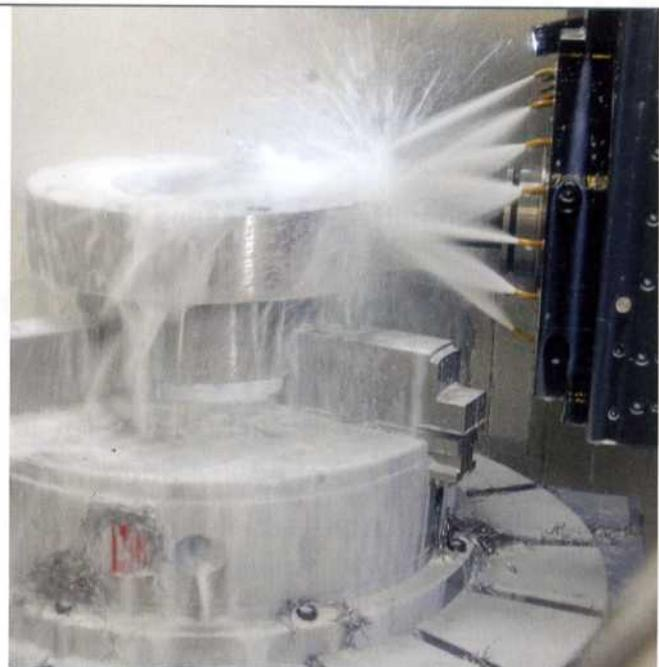
**3** Die neu entwickelte Spritzwasserkante des Röhmspannfutters lenkt das Medium optimal
