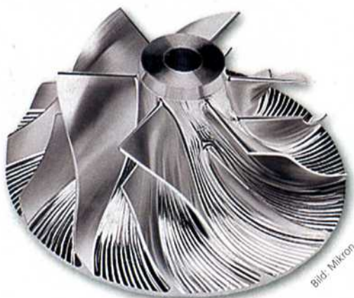
Bild 4: Ein weiteres Beispiel für das Bearbeitungsspektrum der XT-200 ist dieser Turbolader-Impeller.
