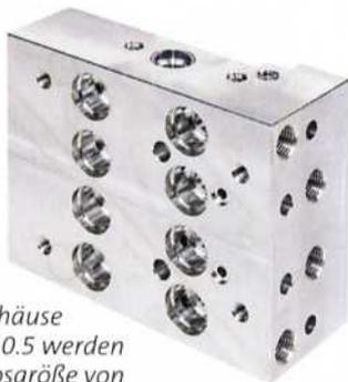
Die ABS-Gehäuse aus AlMgSi 0.5 werden mit einer Losgröße von 300 000 Stück pro Jahr auf einer viermoduligen Maschine produziert
