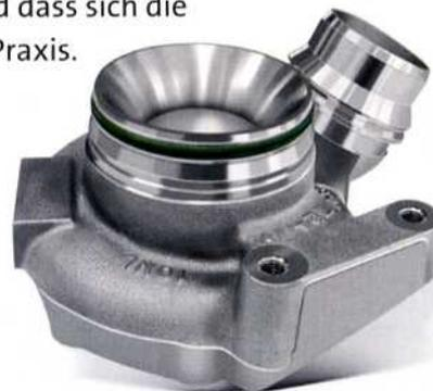
Die fünf Varianten des Turboladergehäuses sind je nach Typ in einer Aufspannung auf fünfeneinhalb Seiten mit 30 bis 40 Bearbeitungsschritten zu bearbeiten
