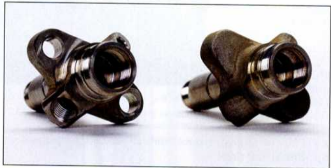
Différentes opérations de perçage et de fraisage sont effectuées par usinage sur l'ébauche en acier trempé.
