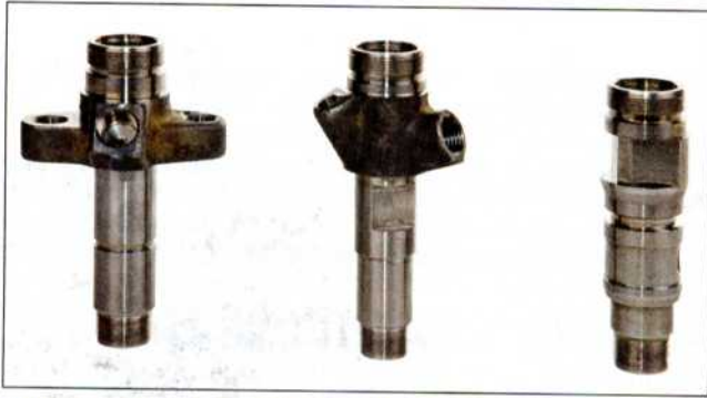
Un gros sous-traitant automobile chinois fabrique trois modèles de porte-injecteurs pour pompes d'injection Common Rail sur un centre d'usinage Multistep XT-200 de Mikron.
