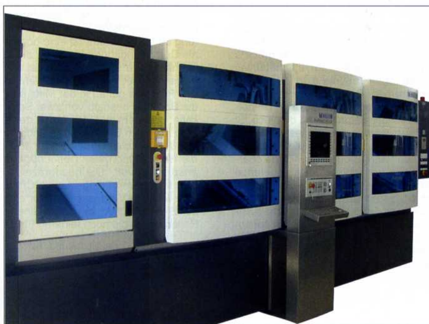
Système d'usinage modulaire Multistep XT-200 de Mikron pour un sous-traitant automobile chinois.
