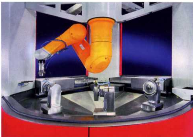
Der Handlingroboter wurde kopfüber an der oberen Verstrebung der Poliermaschine befestigt, was verschiedene Vorteile im Prozess bietet
