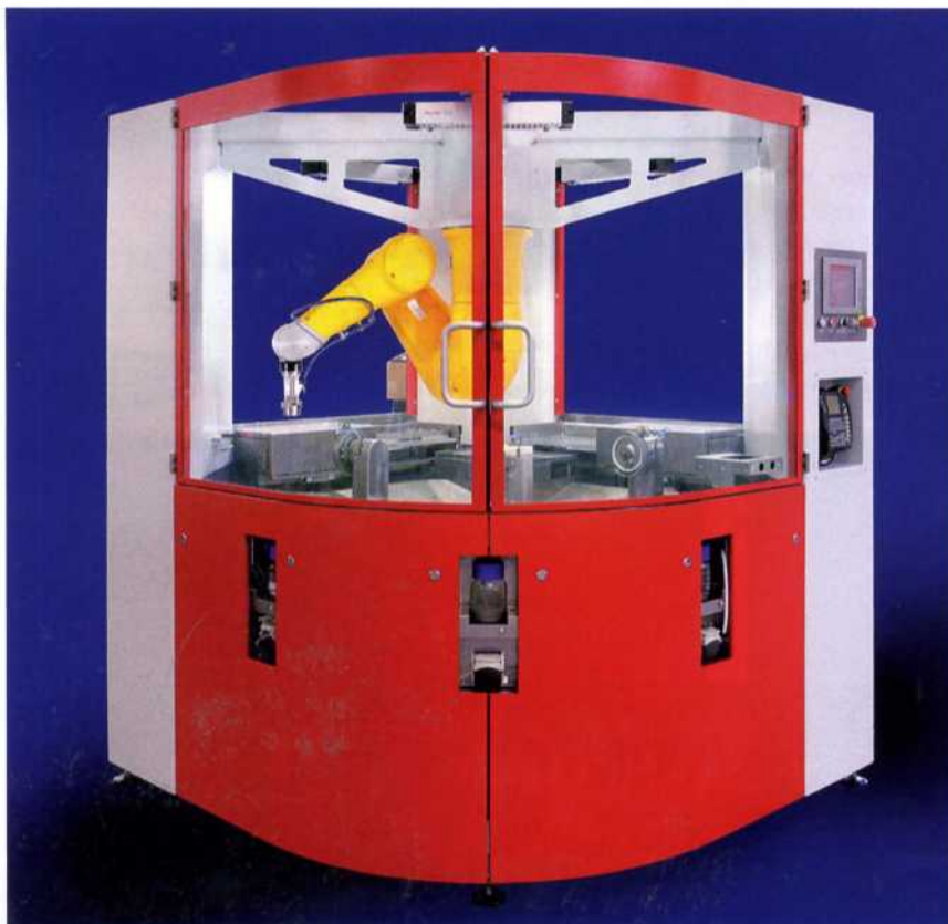
Ein neu entwickeltes Polierverfahren bringt Keramik für Design- und Sichtteile in Premiumfahrzeugen auf Hochglanz
