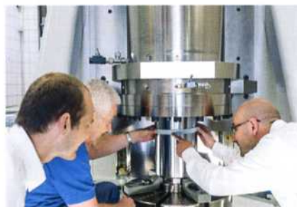
In dem Prüfstand lassen sich auch in einem einzigen Prüfaufbau komplette Dichtsysteme prüfen, die beispielsweise aus Primär- und Sekundärdichtungen bestehen.
