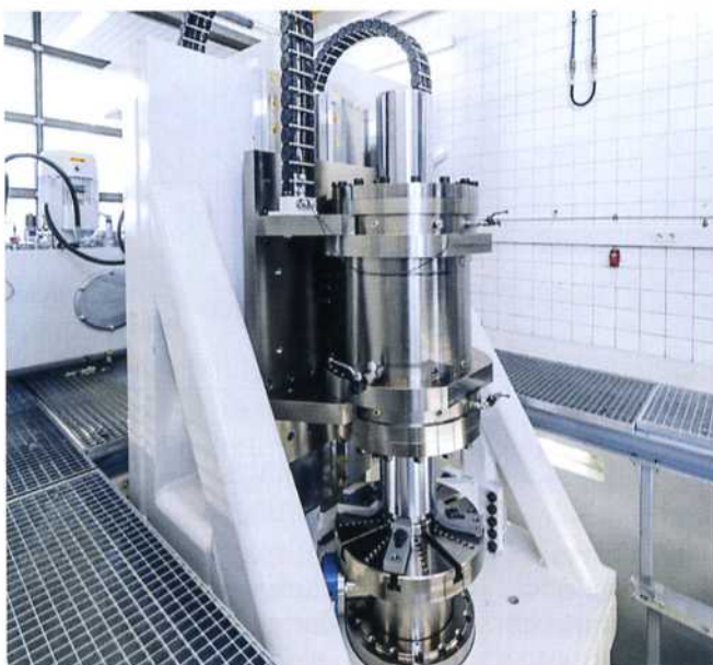
Mit 260 kW verfügt der schwingend gelagerte Prüfstand für Stangendichtungen über die Leistung eines Sportwagens.
