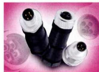
1,5-mm-Kontakte im M12-Bauraum mit neuer, genormter T-Kodierung untergebracht werden. Durch die neue Kodierung wird ein Fehlstecken mit anderen M12-Versionen ausgeschlossen. Anstatt wie bisher 4 A lassen sich jetzt 12 A bei 60 V (DC) übertragen. Durch die vergoldeten Kontaktoberflächen liegt der Durchgangswiderstand bei unter 3 mΩ. Die Steckverbinder sind im gesteckten und verriegelten Zustand nach IP67 dicht. (rh)
