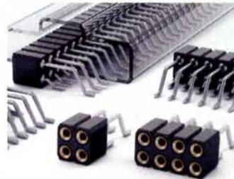
CuSn6 eingesetzt. Die Oberfläche der Hülse inklusive Lötanschluss ist verzinkt (Reinzinn), während die Kontaktfeder vergoldet ist. Eine sichere Funktion ist in dem Temperaturbereich von -40 °C bis +163 °C gewährleistet. (rh)
