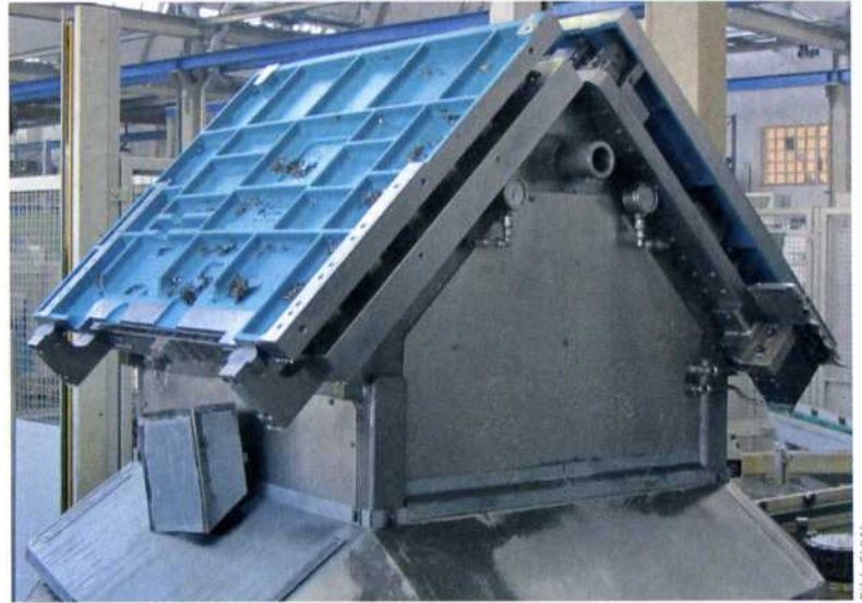
Bild 2: Zwei Rohteile werden gegeneinander aufgestellt, wobei eines auf der Oberseite und eines auf der Unterseite bearbeitet wird. So entsteht bei jedem Durchgang ein Fertigteil.
