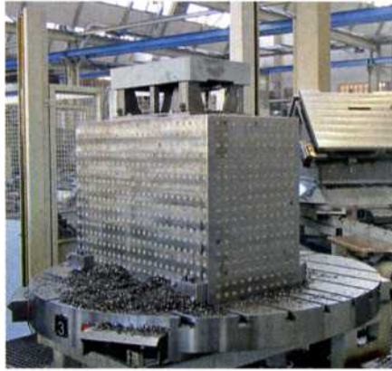
Bild 4: Zusammen mit einem Palettenwechsler lassen sich vier Aufträge ab Losgröße eins bearbeiten und hauptzeitparallel vorrüsten.
