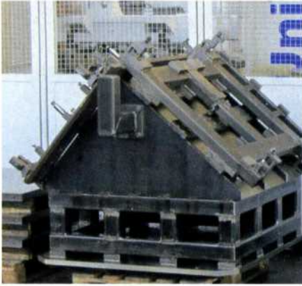
Bild 3: Die teilweise hydraulisch unterstützte, automatische Spannvorrichtung eignet sich für vorhandene Grundaufnahmen.
