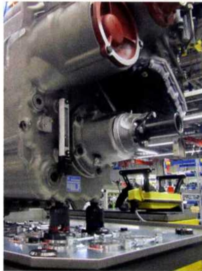
Mit AMF-Nullpunktspanntechnik wird auch das 1,9 Tonnen schwere, stufenlose Hightech-Getriebe Eccom 4.5 gespannt.
