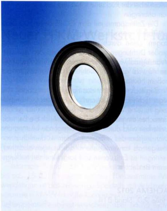
Der Hygienic Usit ist außendichtend, schließt sauber den Bereich zwischen der Schraube und der Oberfläche für jegliche Art äußerer Einflüsse und schützt so das Produkt zuverlässig. Zudem ist der Dichtwulst vom Hygienic Usit aus 70 EPDM 291, das konform gemäß FDA und EU VO 1935/2004 ist, biologisch unbedenklich nach USP Class VI – 121 °C und somit die optimale Wahl auch für hygienisch kritische und anspruchsvolle Anwendungen der Prozessindustrie.
