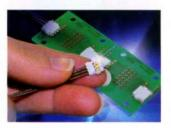
ist für 3 A ausgelegt unter Anwendung des vorgegebenen Kabeldurchmessers mit AWG 22. »DF59« ist derzeit mit zwei, drei und vier Kontakten verfügbar und deckt somit die Anforderungen für monochrome und farbgebende Beleuchtung (RGB) ab. Weitere Polzahlen sind in Planung. (rh)
