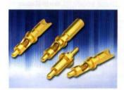
strom-Federkontakten (Pogo-Pins/Batterieladekontakte) erweitert. Die Einzelfederkontakte mit 9 A Strombelastbarkeit gibt es mit Crimpanschluss, Lötkelch oder mit Leiterplattenstift zum Verlöten. In jedem der Federkontakte wird eine vergoldete Edelstahlfeder verwendet, die bis zu einer Million Kontraktionszyklen gewährleisten soll. Die Einpresstiefe wird mit maximal 2,286 mm, die optimale Arbeitsposition (halber Federweg) mit 1,143 mm angegeben.
