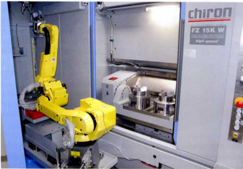
Das automatisierte Fertigungszentrum Chiron FZ 15 Magnum bei Werder ermöglicht auch dank Spanntechnik von Röhm bedienerlose Geisterschichten. (Bilder: Fürst)
