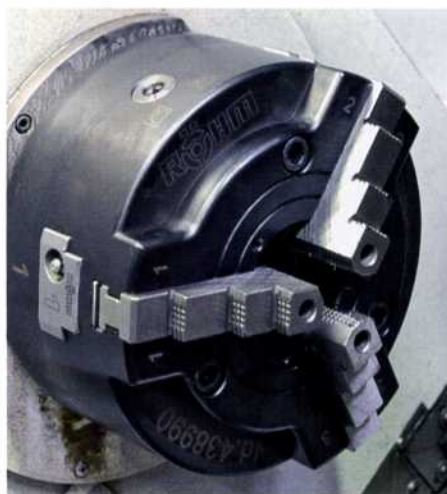
Das kraftbetätigte Spannfutter Duro-NC AW verfügt über einen vergrößerten Freiraum auf der Futtervorderseite
