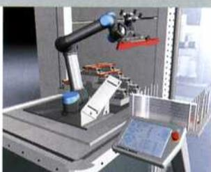
Erowa Universal Robot: Be- und Entladen von Vorrichtungen mit Rohlingen, fleißig und immer zuverlässig.
