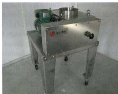
Die leistungsfähige Siebmühle Anugran eignet sich zum Granulieren von trockenen, feuchten oder fettigen Produkten. Auch löst sie Klumpen und Agglomerate auf, die sich beispielsweise nach Transport oder Lagerung im Big Bag gebildet haben und macht das Schüttgut vor dem Weiterarbeiten wieder rieselfähig. Der langsam drehende Rotor kann je nach Anwendungsfall oszillierend oder rundlaufend angetrieben
