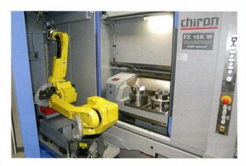
Das neue Fertigungszentrum Chiron FZ 15 Magnum bei Werder mit FlexCell Uno Roboter von Fanuc ermöglicht auch dank Röhm Spanntechnik mannlose Geisterschichten.
