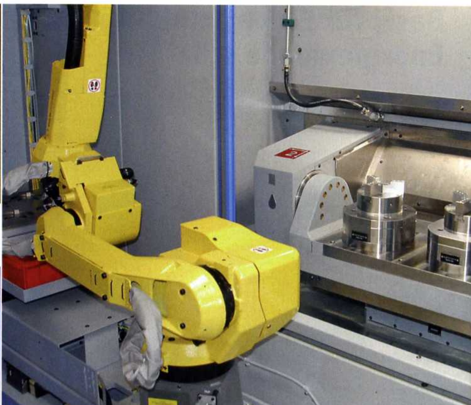
► Zerspanungstechnik: Mit maßgeschneiderten Spannlösungen wird bei der Dreh- und Fräsbearbeitung die gewünschte Flexibilität und Produktivität erreicht. Im Bild: Das Fertigungszentrum mit Roboter ermöglicht im Zusammenspiel mit der Spanntechnik mannlose Geisterschichten. (Titelbild: Röhm) 30
