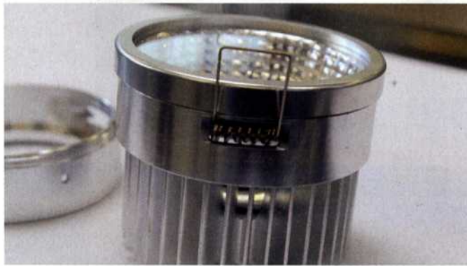
Bild 4: Bei der LED-Leuchte muss in die Aufnahme eine Nut gefräst werden.
