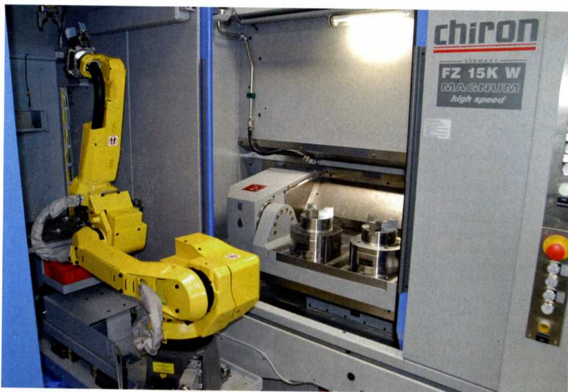
Bild 1: Das Fertigungszentrum von Chiron mit Roboter ermöglicht im Zusammenspiel mit der Spanntechnik mannlose Geisterschichten.
