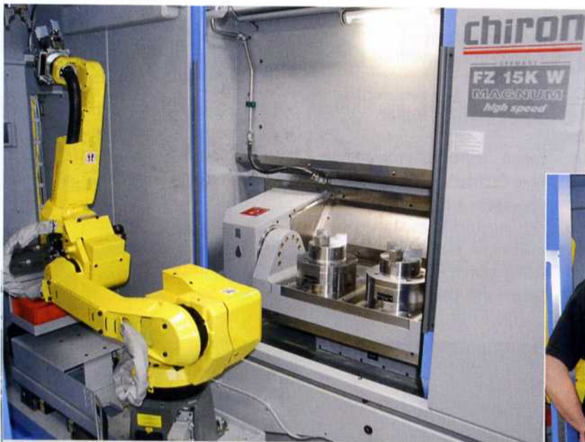
Das neue Fertigungszentrum Chiron FZ 15 Magnum bei Werder mit Flexcell Uno Roboter von Fanuc ermöglicht auch dank Röhm Spanntechnik mannlose Geisterschichten
