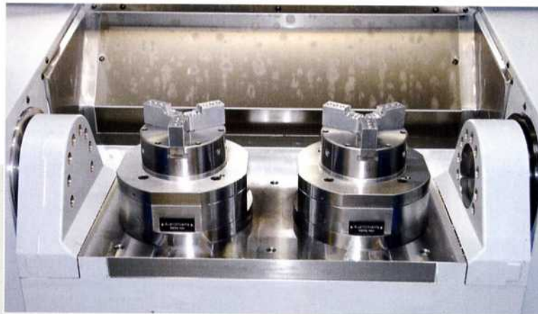
Das Röhm-Spannfutter spannt mit höchster Präzision. Dabei lässt sich die Spannkraft sehr fein dosieren, so dass auch leicht verformbare Werkstücke sicher fixiert werden können (oben)
