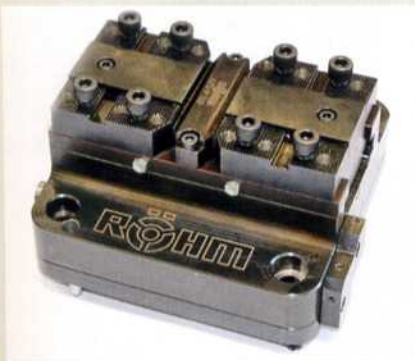
Die Grundbacken mit Spitzverzahnung und Kreuzversatzschnittstelle fahren einen Hub von 3,2 Millimetern und erlauben das Aufsetzen der bei Werder vorhandenen Spannbacken
