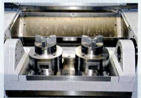
Pneumatisch betätigte PKF-Spanner sorgen für Flexibilität und Produktivität. Hauptzeitparalleles Be- und Entladen ist von der ausgeschwenkten Tischseite möglich
