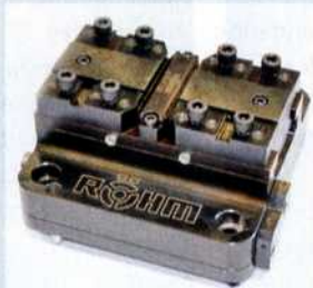
KZSP-Zentrischspanner: Die Grundbacken mit Spitzverzahnung und Kreuzversatzschnittstelle fahren um 3,2 mm. Auch vorhandene Spanbacken können aufgesetzt werden
