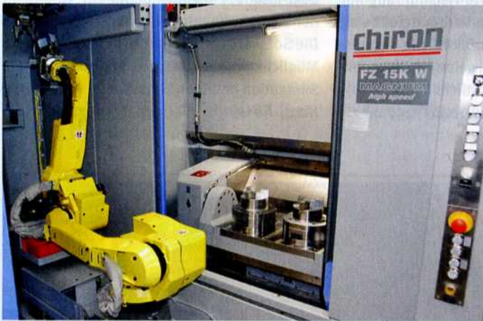
Das Fertigungszentrum FZ 15 Magnum mit Automationszelle FlexCell Uno fertigt in Kombination mit der angepassten Spanntechnik von Röhm in mannlosen Schichten Bilder: Röhm
