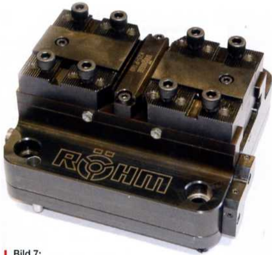
Bild 7: Die Grundbacken mit Spitzverzahnung und Kreuzversatzschnittstelle fahren einen Hub von 3.2 Millimetern und erlauben das Aufsetzen der bei Werder vorhandenen Spannbacken
