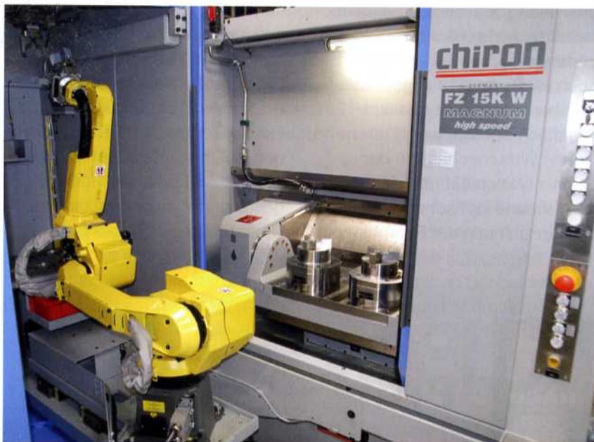
Bild 1: Das neue Fertigungszentrum Chiron FZ 15 Magnum bei Werder mit FlexCell Uno Roboter von Fanuc ermöglicht auch dank Röhm Spanntechnik mannlose Geisterschichten
