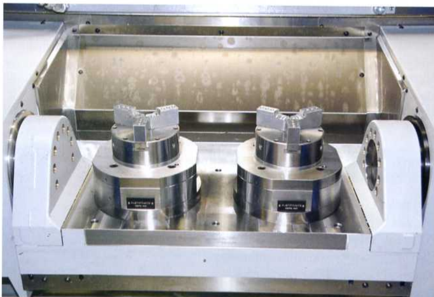
Bild 6: Pneumatisch betätigte PKF-Spanner von Röhm sorgen für Flexibilität und Produktivität. Hauptzeitparalleles Beladen und Entnehmen von der ausgeschwenkten Tischseite
