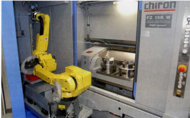
Das Fertigungszentrum Chiron FZ 15 Magnum bei Werder mit Flexcell Uno Roboter von Fanuc ermöglicht auch dank Röhm Spanntechnik mannlose Geisterschichten
