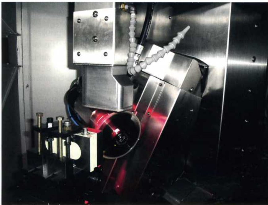
Bild 2: Alle Schleifprozesse werden überwacht von einer digitalen CCD-Videokamera, die über ein numerisches Zoom den Schleifbereich zwischen fünffach und 300-fach vergrößern kann (Werkbilder: Amada Machine Tools Europe GmbH, Haan)
