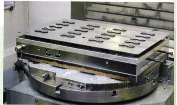
Magnetspanntechnik unterstützt zusammen mit Nullpunkt-Spannsystemen die Fertigungsautomatisierung
