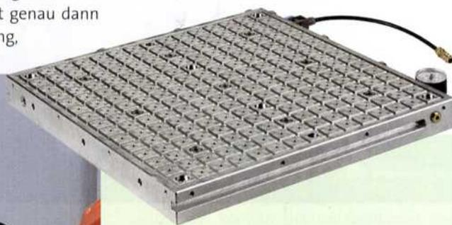
Die Vakuum-Spanntechnik von AMF ermöglicht eine verzugs- und schwingungsfreie Fünf-Seiten-Bearbeitung von vorwiegend dünnwandigen, nicht magnetischen Teilen bei nur einer Aufspannung
