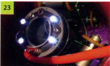
23 Im Rohrinne prüfen, schleifen, schweißen, bergen oder absaugen - dieses Gerät kann es.
