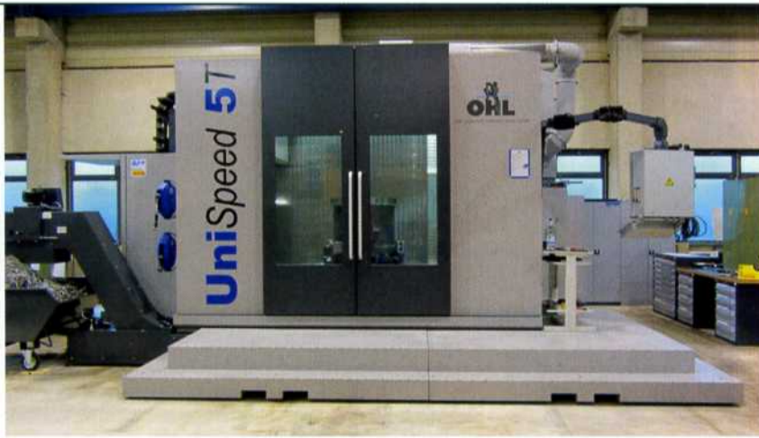
2 Dreh-Fräs-Zentrum UniSpeed 5T von SHW Werkzeugmaschinen mit Verfahrwegen von X = 2000 mm, Y = 1300 mm und Z = 1300 mm und für die Bearbeitung von Werkstücken bis zu einem Gewicht von sechs Tonnen
