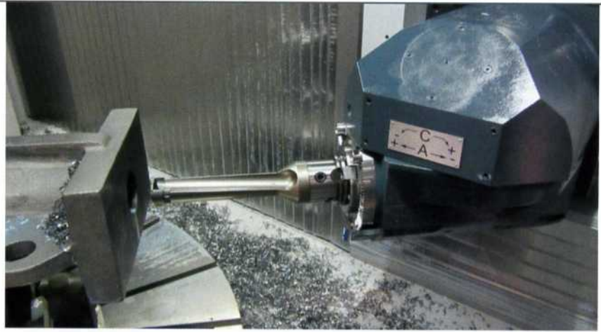
4 Weil der Orthogonalkopf der UniSpeed 5T sehr kompakt ist, schwenkt er vollautomatisch in jede gewünschte Position, ohne den Arbeitsraum einzuschränken
