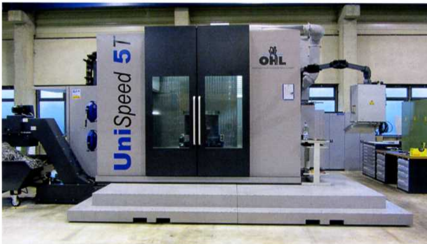
Bild 2: Dreh- Fräszentrum UniSpeed 5T mit Verfahrenswegen von X = 2.000 mm, Y = 1.300 mm und Z = 1.300 mm und für die Bearbeitung von Werkstücke bis zu einem Gewicht von sechs Tonnen
