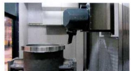
Bild 4: Der kompakte und kraftvolle Orthogonalkopf erreicht 64.800 Positionen
