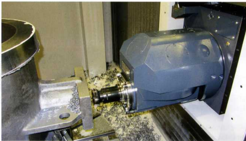
Bild 5: In einer Aufspannung möglichst viele Operationen durchführen erhöht die Präzision
