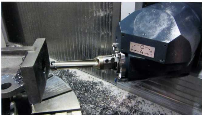
Bild 7: Weil der Orthogonalkopf der Uni-Speed 5T sehr kompakt ist, schwenkt er vollautomatisch in jede gewünschte Position, ohne den Arbeitsraum einzuschränken
