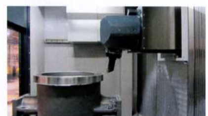
Bild 4: Der kompakte und kraftvolle Orthogonalkopf erreicht 64.800 Positionen
