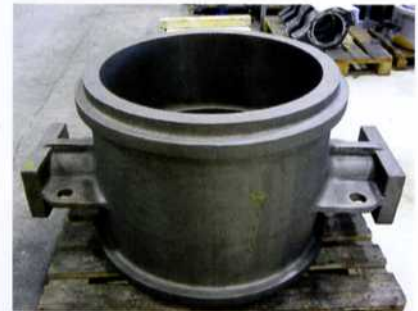
Bild 1: Rund 650 kg bringt der aus Stahlguss gegossene Rohling der Absperrklappe auf den Werkstücktisch des Bearbeitungszentrums
