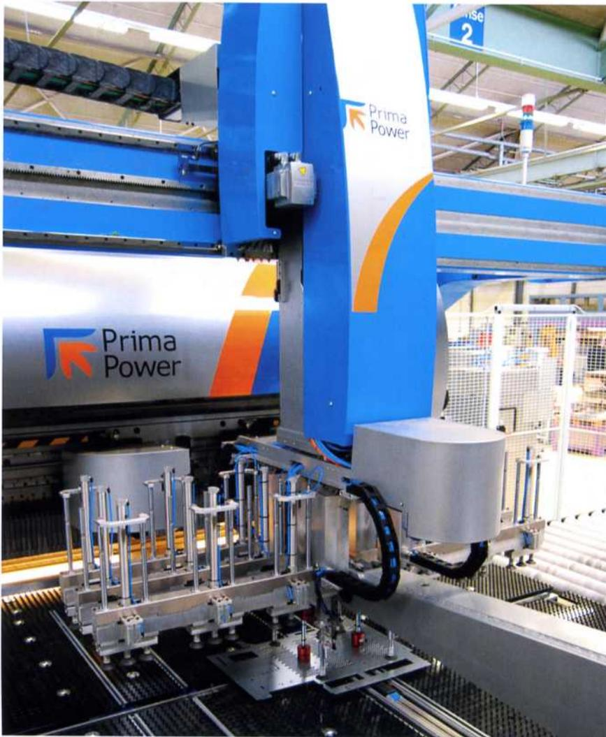
Bild 4: Auf dem Weg zur hydraulikfreien Maschine: Sowohl die Stanz-Einheit als auch die Biegemaschine arbeiten servo-elektrisch
