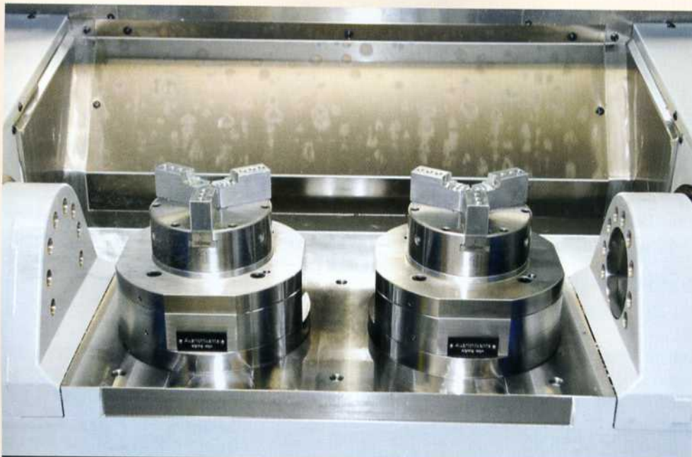
Pneumatisch betätigte Zentrischspanner KZSP 160 von Röhme sorgen für Flexibilität und Produktivität.
