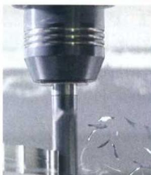
Das neue Hydro-Dehnspannfutter TENDO E compact von Schunk für die Volumenzerspannung überträgt unter trockenen Spannungsbedingungen Drehmomente bei Ø 20 mm bis 900 Nm und bei Ø 32 mm bis 2000 Nm. Seine Leistung liegt 60% über der konventioneller Hydro-Dehnspannfutter. Mit seiner Schwingungsdämpfung und
