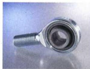
Gelenkköpfe sind nach DIN ISO 12240 genormt und bestehen aus einem Stangenkopf, der am Schaftende entweder mit einem Innen- oder Außengewinde versehen ist oder eine Anschweißfläche aufweist. In der Gehäusepassung dieser
