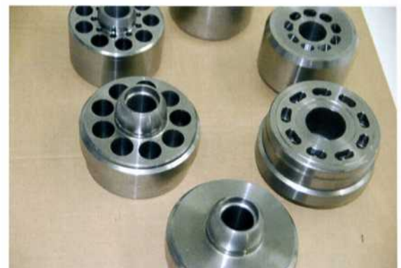
Bild 3: Werkstücke aus Aluminium und GGG 60 Sphäroguss werden mit einer einzigen Aufspannung sicher durch die Anlage geführt
