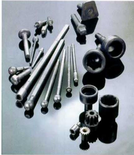
Wenn weniger Material abgetragen werden muss, weil das zu zerspanende Teil endkonturnah vorgeformt ist, sieht auch die Energiebilanz der Fertigungsmaschinen besser aus.
