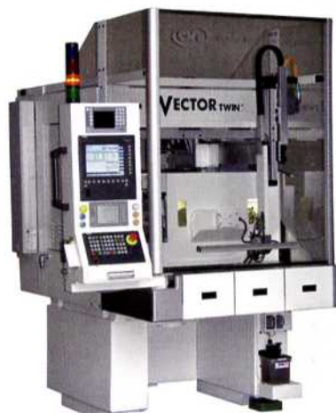
Doppelspindel-Rundschleifmaschine Vector Twin Mark IV des englischen Herstellers Curtis Machine Tools Ltd (CMT) mit 40 % größerem Verfahrensweg
