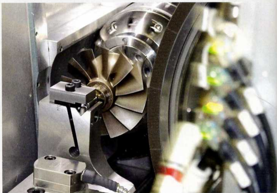
Mit der neuen Doppelspindel-Rundschleifmaschine Vector Twin Mark IV lassen sich zum Beispiel Turboladerwellen feinstbearbeiten
