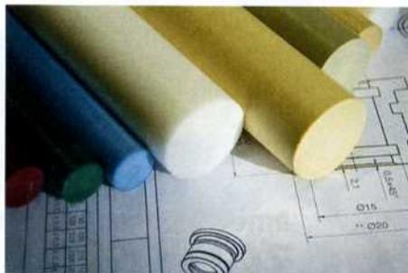
Erweitert wurde das Halbzeugsortiment um die Tribopolymere Iglidur A350 und J350. Das blaue A350 eignet sich für mittlere bis hohe Belastungen und Temperaturen bis +180°C. Darüber hinaus ist der schmierfreie Werkstoff FDA-konform, für saure Umgebungen geeignet und damit prädestiniert für den Einsatz in der Lebensmittelindustrie. Der hochverschleißfeste Kunststoff Iglidur J350 ist Spezial-
