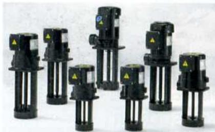
abrasiven Feststoffanteilen, ist korrosionsbeständig und fördert viskose Medien bis 75 cSt ohne den Motor zu überlasten. Da auf den Einbau einer Wellendichtung verzichtet wurde, sind die Pumpen absolut trockenlaufsicher und wartungsfrei. Darüber hinaus kann
