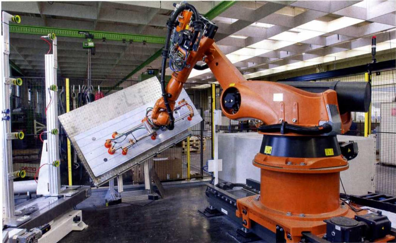
Es ist beeindruckend, mit welcher Leichtigkeit der Roboter mit den großen und schweren Platinen umgeht“, betont Holger Schneeberger, Geschäftsführer der Walter Wurster GmbH. „Früher mussten sich drei Mitarbeiter abmühen, um die Werkstücke zuzuführen und abzunehmen.“ Ein riesiger Kuka-Roboter belädt vollautomatisch eine LVD Biegemaschine, die auf 4.000 mm Biegelänge mit 2.150 kN die Werkstücke mit verschiedenen Werkzeugen biegt und eine Prägung einbringt.
