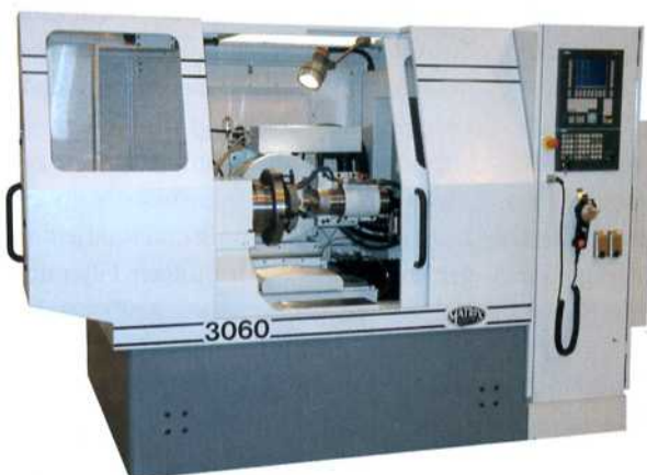
Die kompakte Innengewinde-Schleifmaschine Matrix 3060 verfügt über ein Kreuzschlittensystem, das die Werkzeuge während der Bearbeitung in zwei Achsen führt
