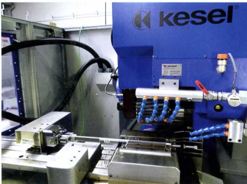
Bild 1: Bei der Produktion der in Fahrzeugen immer stärker aufkommenden Elektrolenkungen erzeugt eine Fräsmaschine der Georg Kesel GmbH & Co. KG aus Kempten die zweite Verzahnung in die Lenkwellenzahnstange
