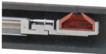
Das von Cloos neuentwickelte Spritzerschutzsystem: Der Auffangbehälter für die Schweißspritzer befindet sich direkt unter der Verbindungsstelle zweier Rohre.
