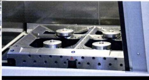
Nullpunktspannsysteme wie die „Turbine“ von AMF ermöglichen die Automatisierung beim Werkstück- und Palettenwechsel
