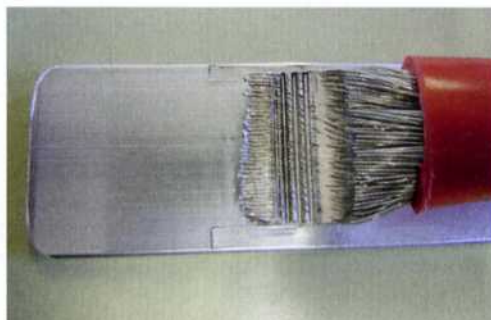
Weltweit einzigartig: Eine Schweißung von 120 mm 2 Aluminiumleitung ist beispielsweise nur 22 mm breit.
