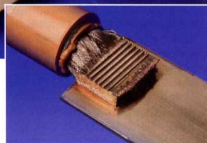
Die PowerWheel-Technologie spart beim Metallschweißen Material, Bauraum und Kosten.
