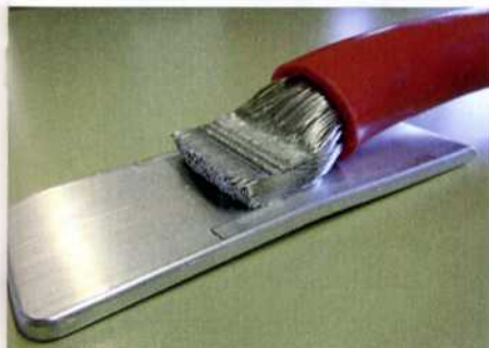
Beim Verschweißen von Litzen sind bis zu 30% schmalere und höhere Knoten möglich.
