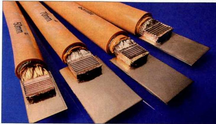
Mit der „PowerWheel“-Technologie von Telsonic können wesentlich größere Kräfte und Leistungen in die Schweißung eingeleitet werden. Bild: Telsonic
