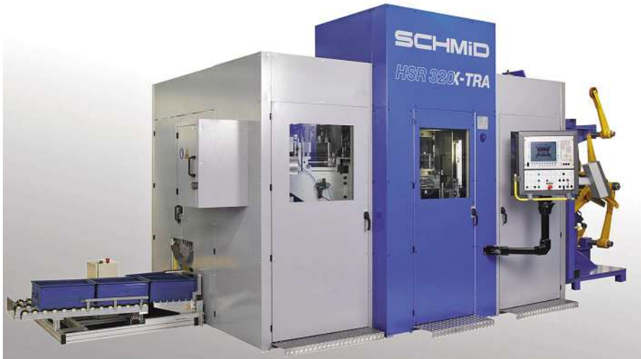
Bild 3: Moderne Feinschneidpressen erreichen heute Hubzahlen von 100 pro Minute und mehr.
