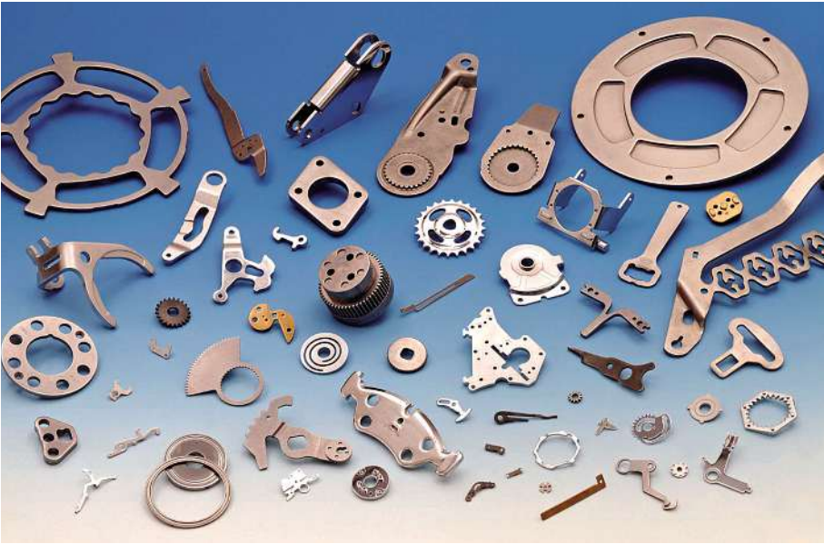
Bild 1: Feinschneiden ermöglicht die Herstellung hochpräziser Teile, deren Schnittflächen nicht nachbearbeitet werden müssen.
