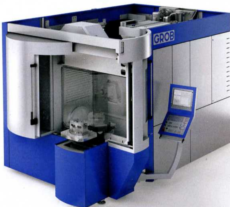
Hydraulikfreies-5-Achs Bearbeitungszentrum mit elektro-mechanischer Paletten- und Werkzeugspannung am Rüstplatz.
