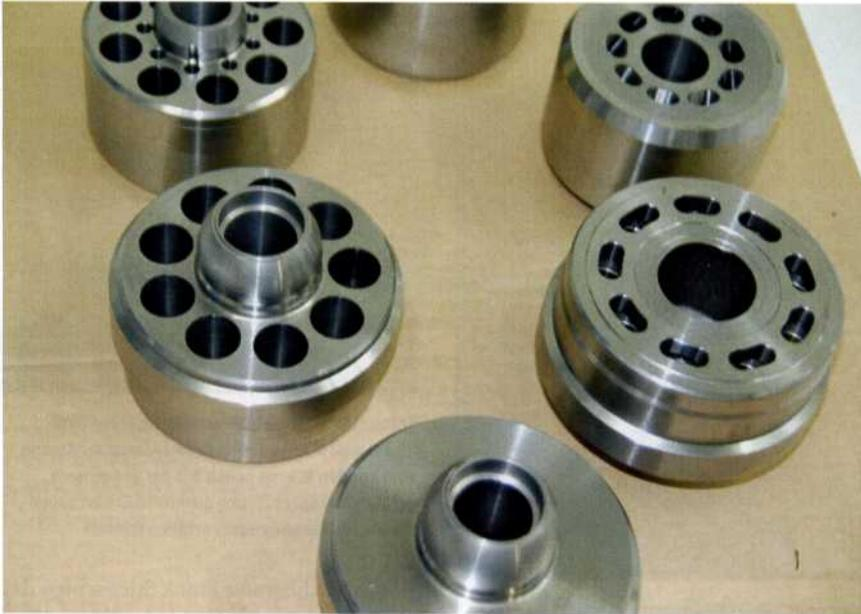
Auf der Maschine in einer Aufspannung fertig bearbeitete Teile aus Alu und GGG 60 für den Hydraulikantrieb in schweren Baumaschinen
