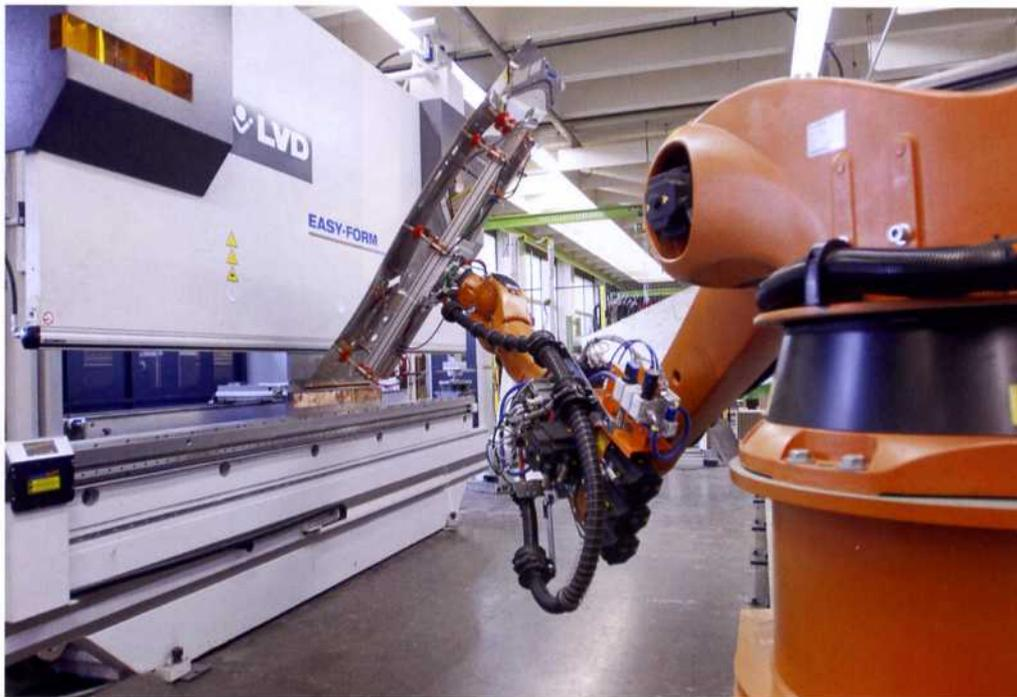
und 27 kg schwer sind die Edelstahl-Bleche, aus denen später Backraum-Ummantelungen für Bäckerei-Backöfen werden. Auf einer sechs Meter langen Achse wird der Roboter linear geführt und kann verschiedene Be- und Entladestationen anfahren. Aufgenommen werden die großen Platinen durch
