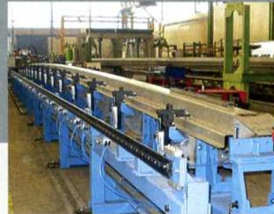
Für Rationalisierungs- und Automatisierungslösungen sind die AMF-Spanner eine wichtige Hilfe. Mehrere Spanner lassen sich gleichzeitig oder unabhängig voneinander in einer bestimmten Reihenfolge betätigen.
