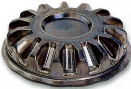
Bild 1: Differenzialkegelräder für Ausgleichsgetriebe von Pkw und Lkw lassen sich sowohl Taumeln als auch Präzisionsschmieden.
