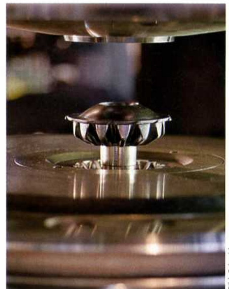
Bild 3: Während das untere Gesenk das Roh-teil gegen das obere Gesenk presst, führt das obere Gesenk eine kreisförmige, taumelnde Bewegung aus.
