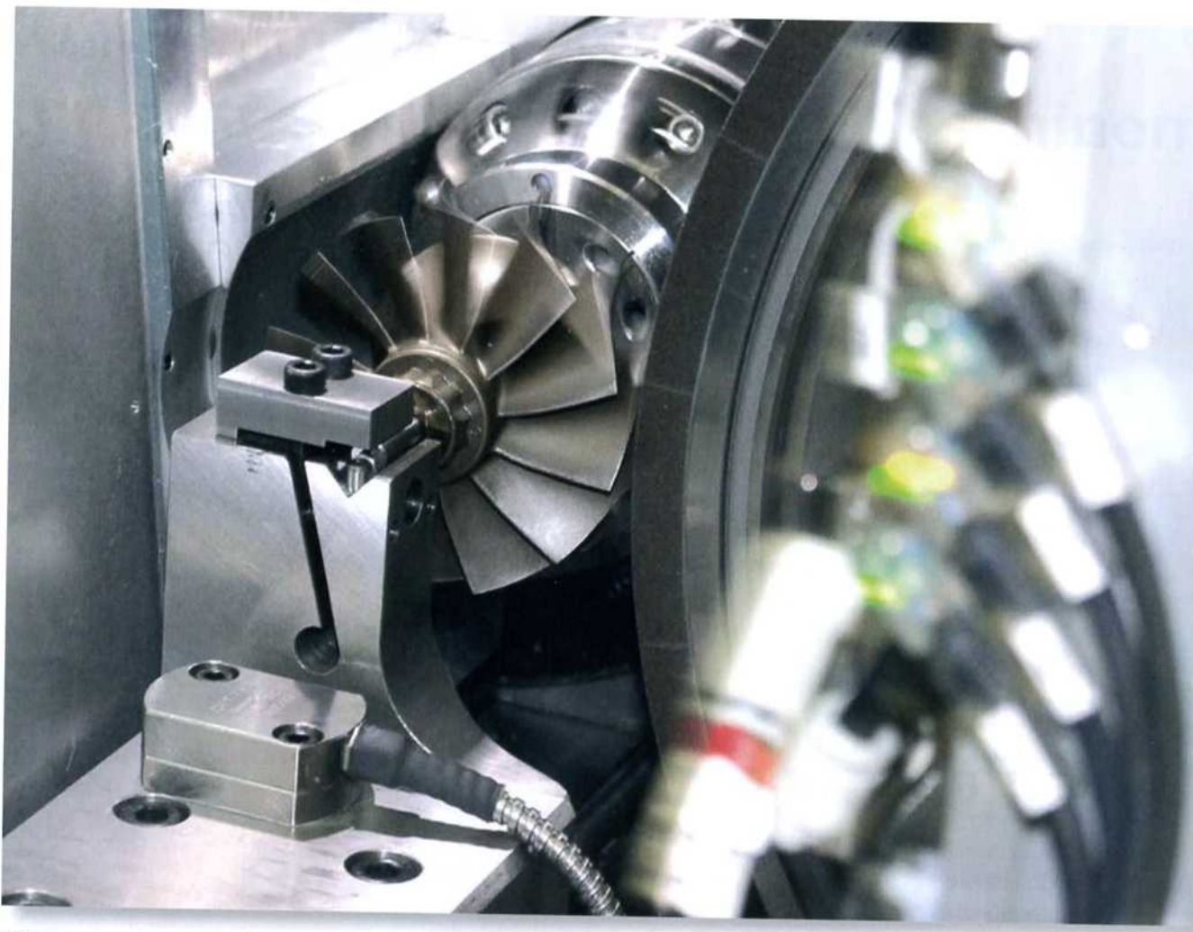
Bild 1: Mit der neuen Doppelspindel-Rundschleifmaschine Vector Twin Mark IV lassen sich zum Beispiel Turboladerwellen feinstbearbeiten
